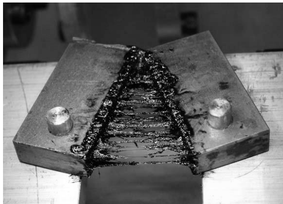
Figura 15: Formação de fibras durante o ensaio
