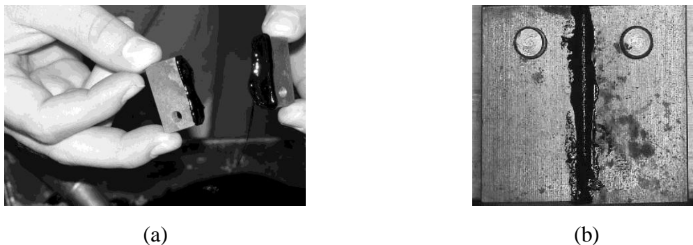
Figura 7: a) Aplicação da mistura asfáltica a ser ensaiada; b) Amostra pronta para ser ensaiada
