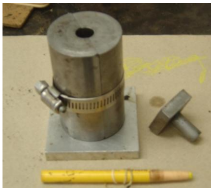
(a) Molde para compactação do corpo de prova e gabarito (1º método)
