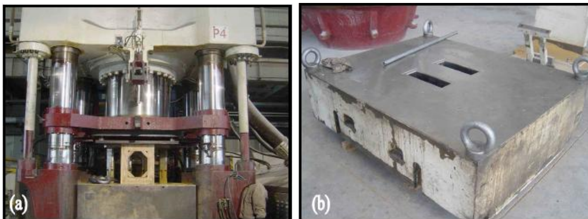
Figura 2: (a) Prensa LAEIS HPF III 2500 e (b) exemplo de fôrma de duas cavidades utilizada. Fonte: Autoria própria
