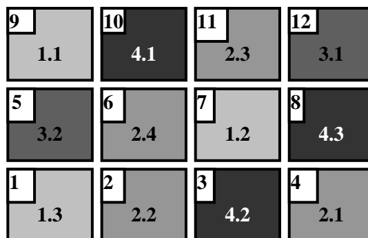
Figura 4: Representação de um chão-de-fábrica como um diagrama em blocos. Neste caso, um arranjo físico distribuído é apresentado.
