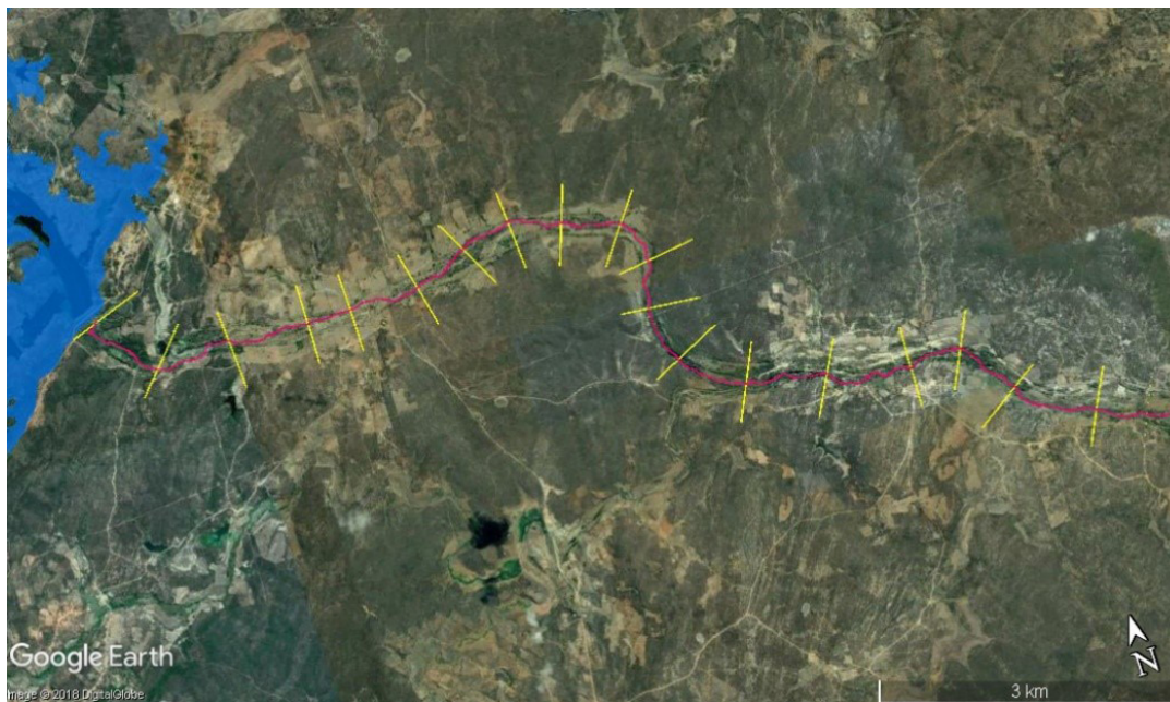
Figura 2 - Detalhe das seções transversais a jusante da barragem Fogareiro.
