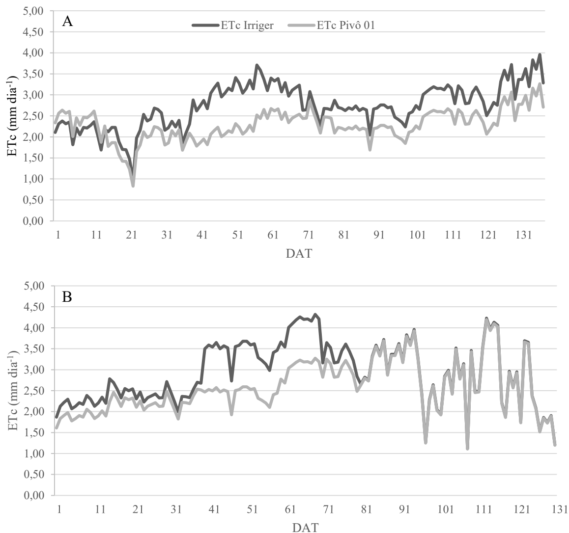
Figura 26. Evapotranspiração da cultura no manejo de irrigação utilizado e na estimativa obtida no pivô 1 (A) e pivô 2 (B).
