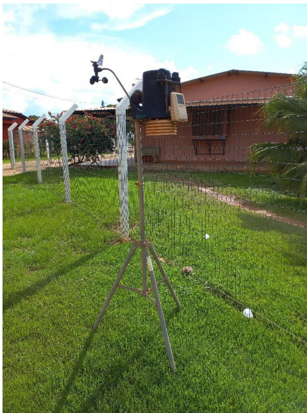
Figura 17. Estação meteorológica automática.
