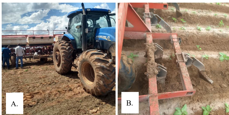
Figura 11. Adubação de cobertura: Cultivador escarificador (A), implemento em operação (B). Fonte: Elaborado pelo autor.
