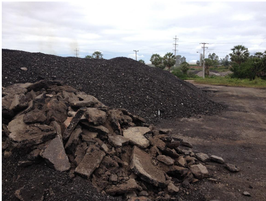
Figura 10 – Pilha de estocagem de fresado da empresa Insttale Engenharia.
