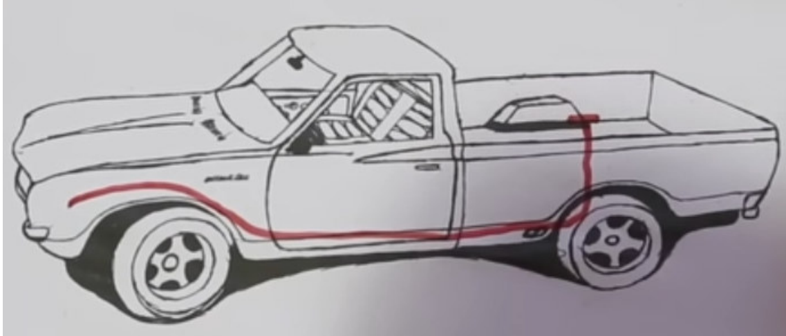
Figura 11 – Cabeamento de um sistema elétrico auxiliar instalado externamente ao veículo.
