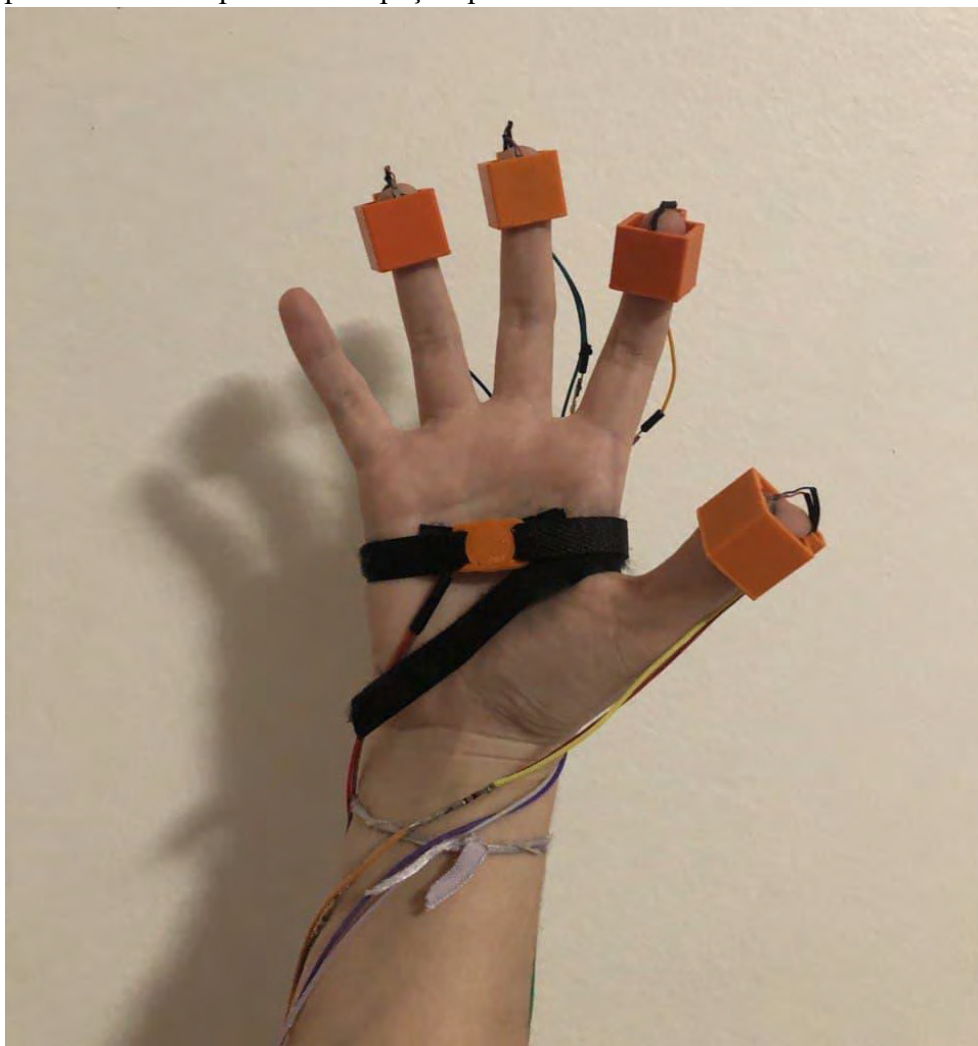
Figura 23 - Visão frontal dos motores de vibração posicionados embaixo da ponta dos dedos por meio de peças que se encaixam nos mesmos.
