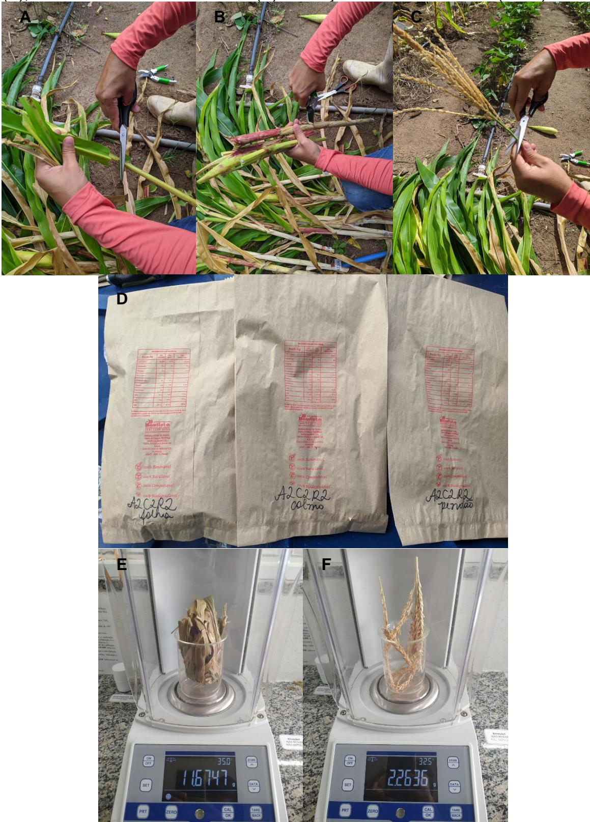
Figura 10 – Divisão das partes da planta de milho em folhas (A), colmo (B) e pendão (C), acondicionamento do material (D) e aferição das massas secas (E e F)
