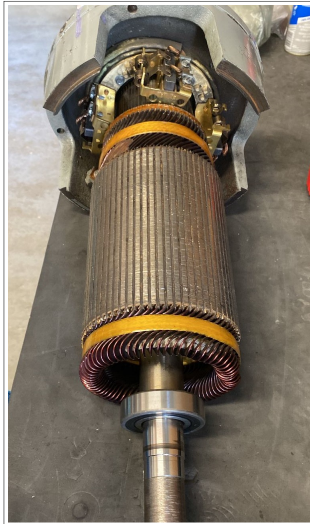
Figura 11 – Circuito de armadura do motor de corrente contínua com excitação independente.
