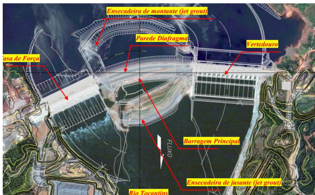
Figura 17 - Arranjo geral da UHE Estreito.
