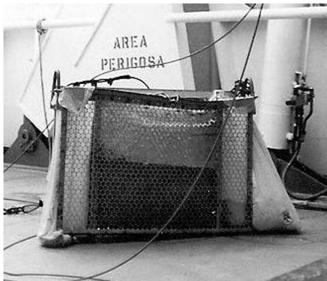
Fig. 2. Draga retangular usada nas coletas de sedimentos a bordo do NOc. Antares.
