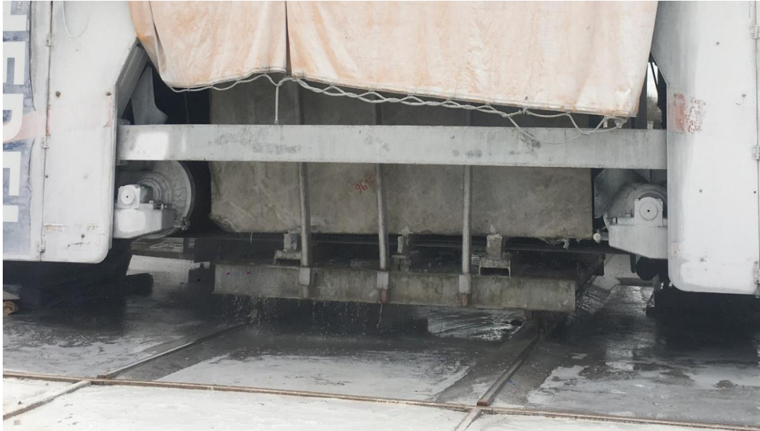
Figura 4 - Desdobramento de blocos em chapas utilizando multifio
