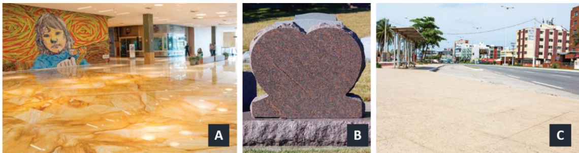
Figura 1 – Aplicações das rochas ornamentais: (a) aplicação em revestimento, piso de shopping; (b) arte funerária; (c) aplicação em pavimentação, revestimento com granito bruto
