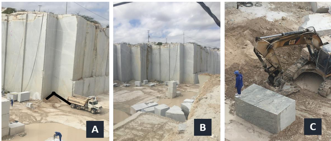
Figura 2 - Lavra por bancadas altas: (a) abertura com geometria em “L”; (b) sequenciamento lateral; (c) blocos extraídos
