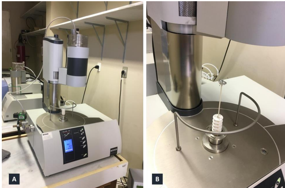
Figura 16 – Equipamento utilizado para análise termogravimétrica: (a) vista geral e (b) vista do porta amostra
