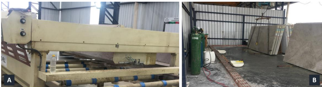
Figura 5 - Técnicas de beneficiamento secundário: (a) equipamento de escovação; (b) flameamento em chapas de rochas ornamentais
