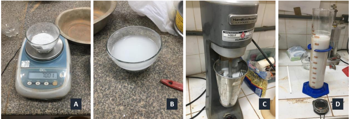
Figura 14 - Sedimentação: (a) 70 g do material passante na peneira de 2 mm; (b) Defloculante adicionado na amostra; (c) Copo de dispersão; (d) Leituras com o densímetro
