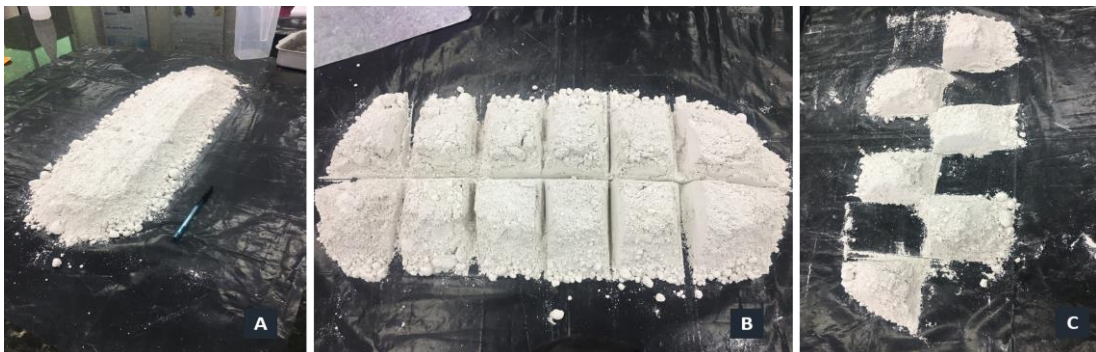
Figura 9 – Pilha longitudinal: (a) Homogeneização; (b) Quarteamento; (c) Formação da amostra
