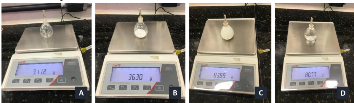
Figura 12 - Imagem ilustrativa das pesagens para determinação da massa específica real: (a) Picnômetro vazio; (b) Picnômetro + amostra; (c) Picnômetro + água + amostra; (d) Picnômetro + água
