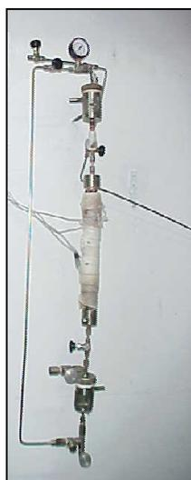
Figura 4.10 – Reator de leito fixo utilizado para os experimentos.
