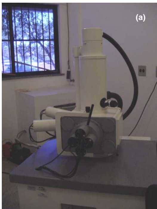
Figura B.3: Microscópio eletrônico de varredura Zeiss, modelo DSM 940A, utilizado nas análises de microscopia eletrônica do suporte e/ou do derivado.
