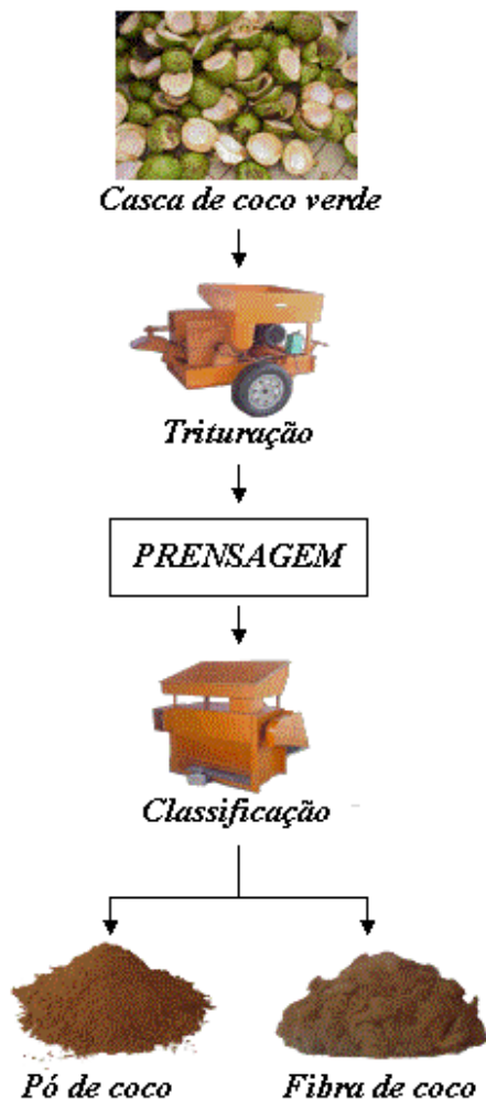
Figura 3.1: Fluxograma do processo de obtenção da fibra de casca de coco verde.
