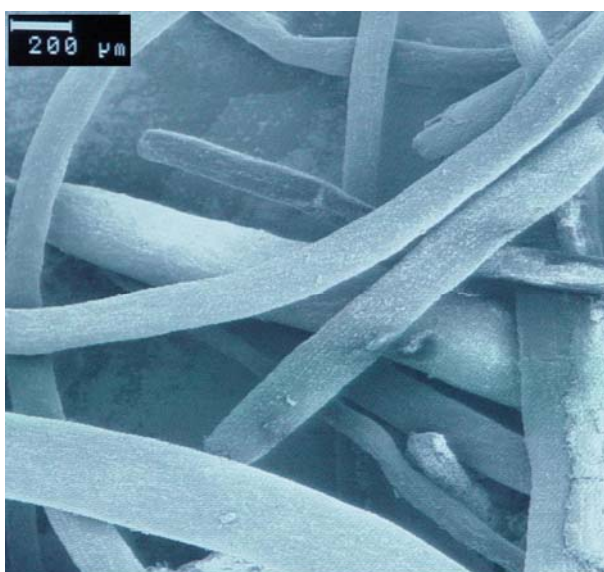
Figura E.1: Microfotografia de amostra de fibra bruta selecionada para análise, com aumento de 50 x.
