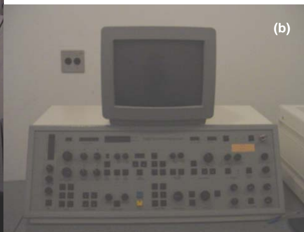
Figura B.3: Microscópio eletrônico de varredura Zeiss, modelo DSM 940A, utilizado nas análises de microscopia eletrônica do suporte e/ou do derivado.
