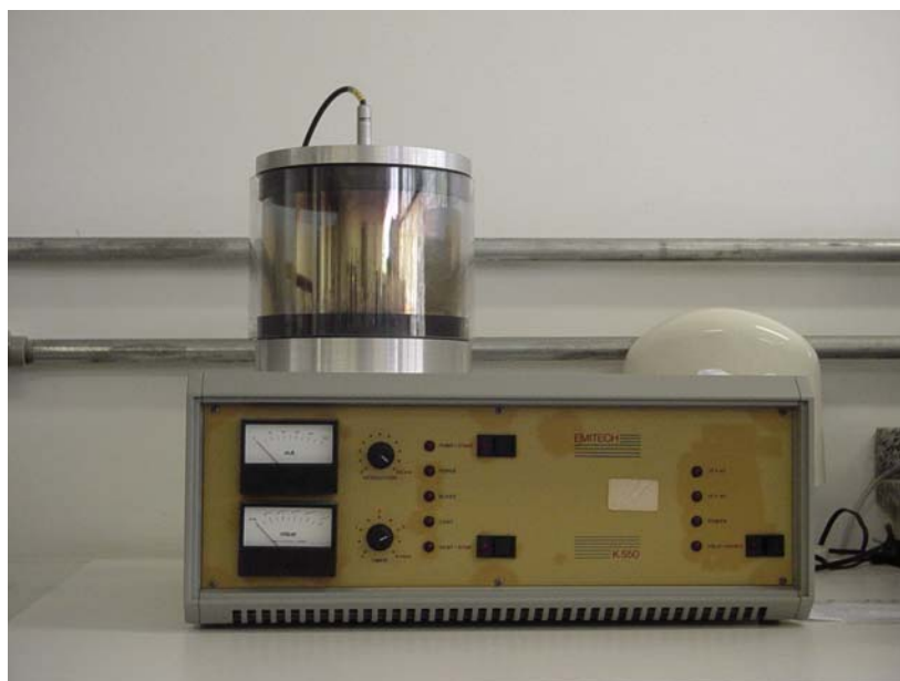
Figura B.2: Metalizador EMITECH, modelo K 550, utilizado para recobrimento da amostra com ouro.
