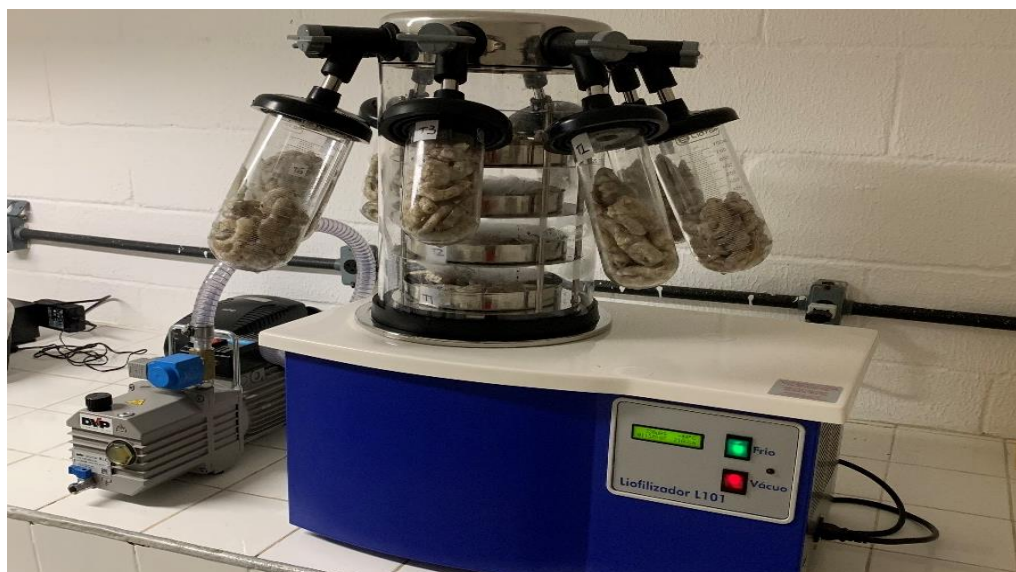
Figura 4 - Liofilizador LIOBRAS® L101.
