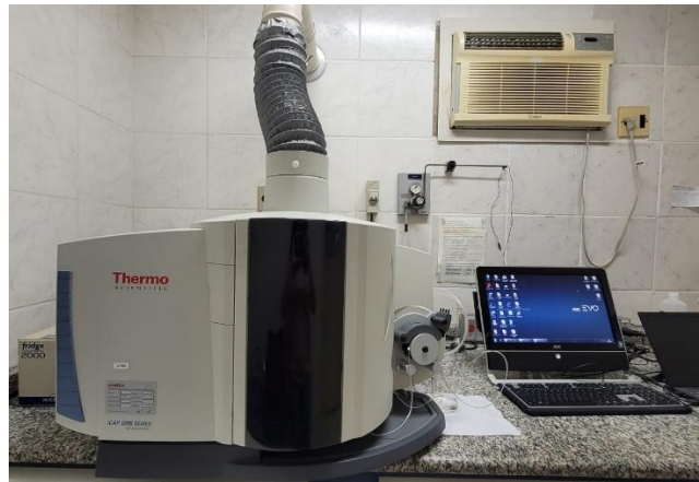
Figura 6 – Equipamento ICP OES
