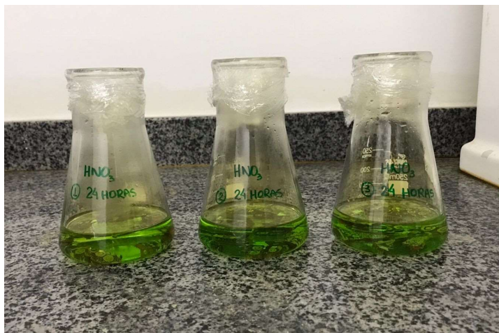
Figura 3 – Sistema de lixiviação montado para o experimento
