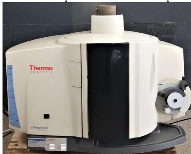
Figura 5 – Equipamento analítico que realiza a técnica de espectrometria de emissão óptica.
