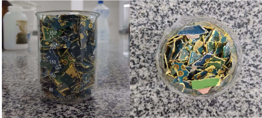
Figura 2 – Placas de circuito impresso após processamento manual
