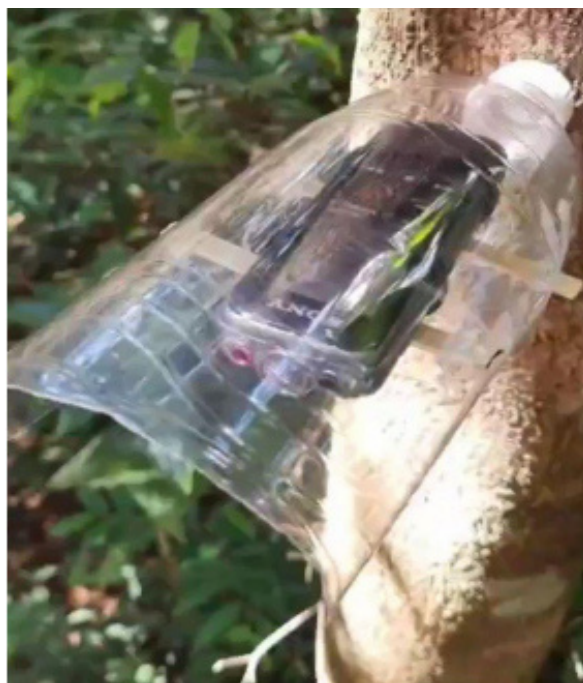
Figura 6 – Gravador Sony PX240 dentro de uma garrafa PET, apoiado em palitos e fixados com seladores de plástico.
