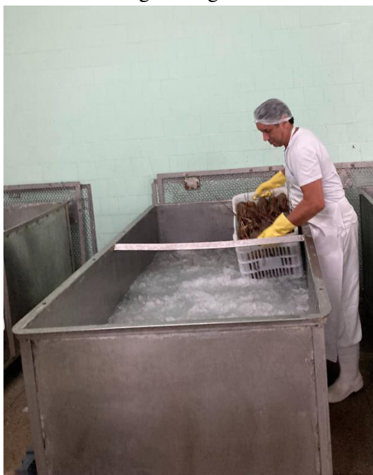
Figura 6 – Imersão da lagosta viva inteira em solução de metabisulfito de sódio ( \text{SO}_2 ) com gelo e água.
