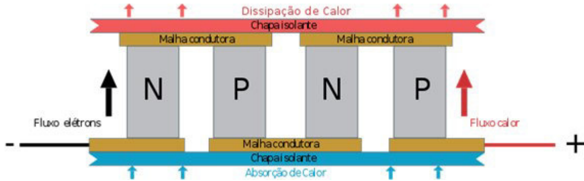
H Figura 14 – Célula contendo materiais semicondutores onde pode ser avistado um gradiente de calor gerado pelo efeito Peltier.
