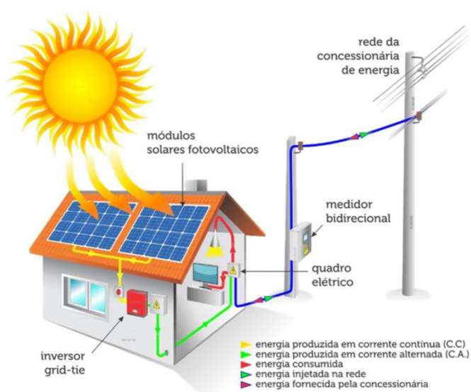
Figura 4 - Esquemático de um sistema FV conectado à rede
