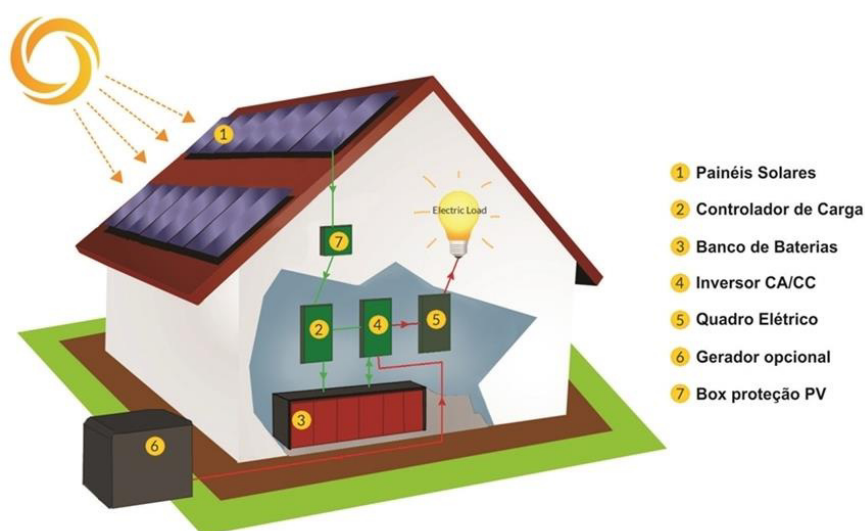
Figura 3 - Esquemático de um sistema FV isolado.
