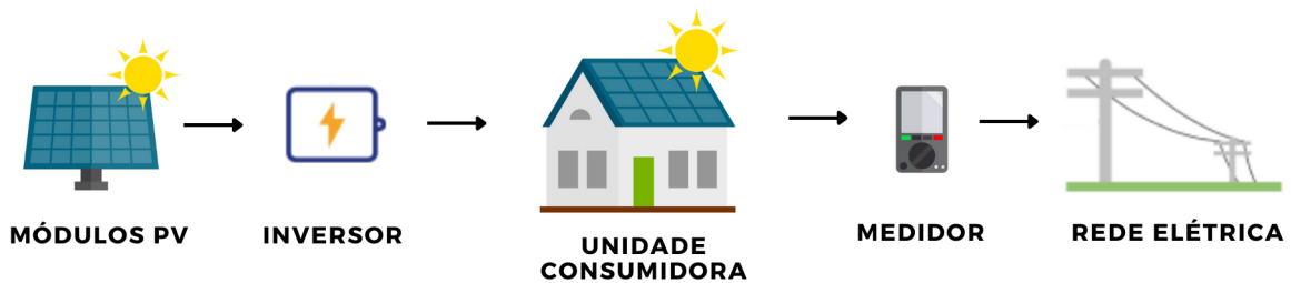
Figura 7 – Esquema de sistema fotovoltaico On-grid .
