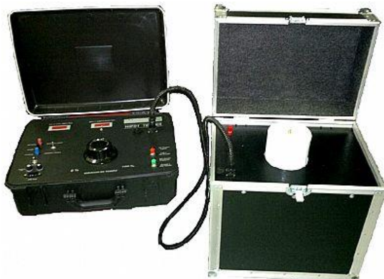
Figura 18 - Hipot de Alta Tensão CA 100 kVA 50 mA
