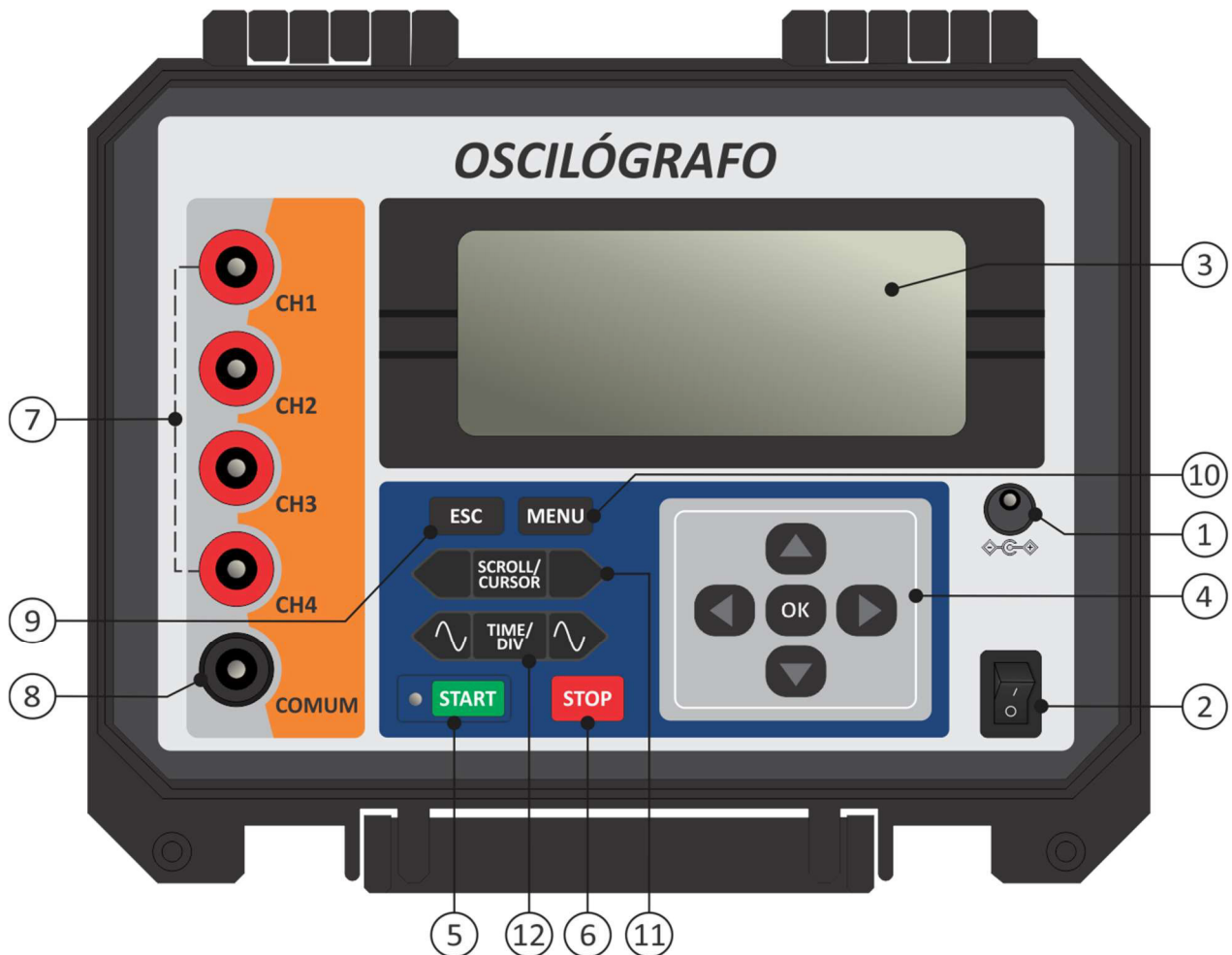
Figura 21 - Principais elementos de um oscilógrafo digital
