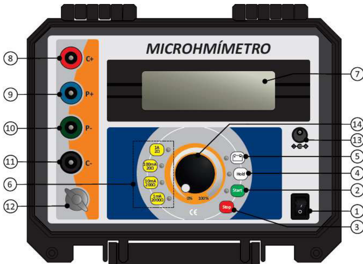
Figura 18 - Principais elementos de um microhmímetro digital
