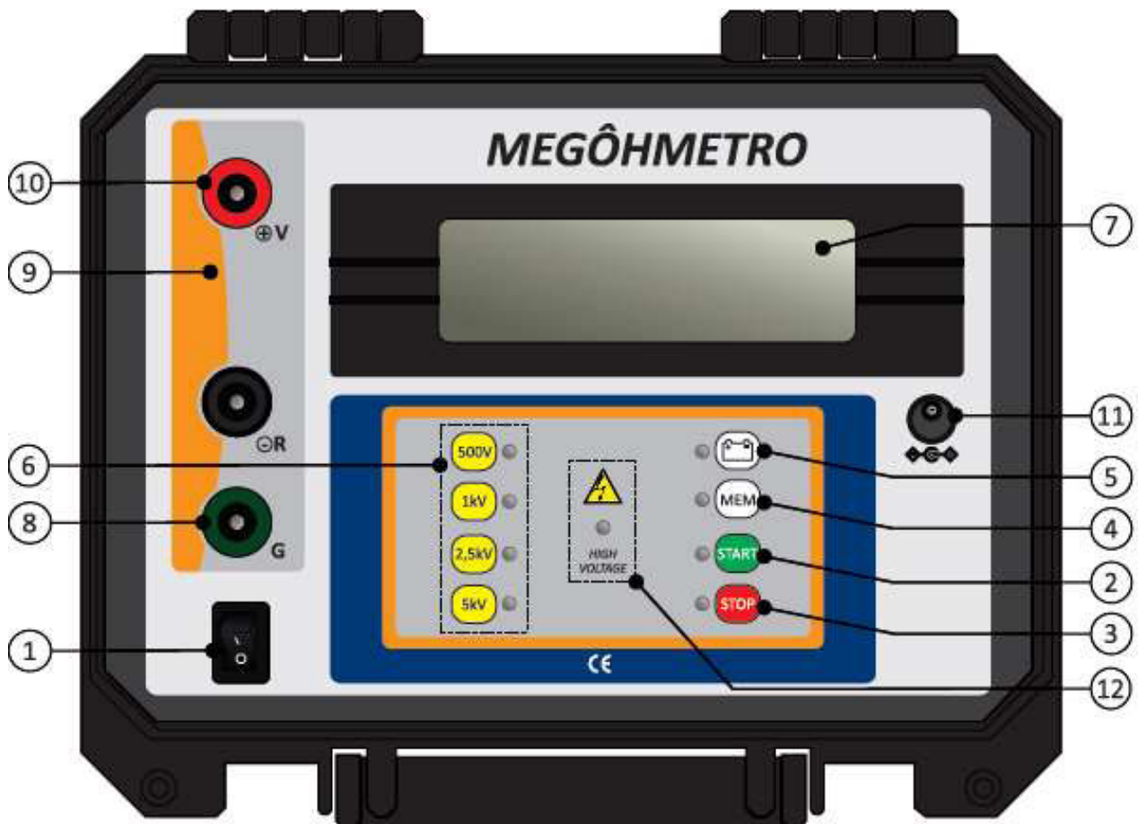
Figura 12- Principais elementos de um megôhmetro digital.
