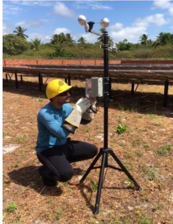
Figura 30 – Fixação da Estação meteorológica em campo
