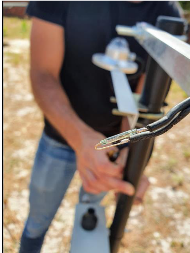
Figura 39- Reed Switch do anemômetro que precisou ser trocado
