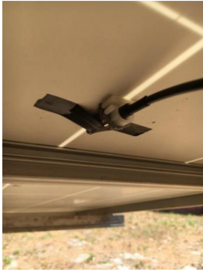
Figura 32 – Maneira de fixação Sensor de Temperatura
