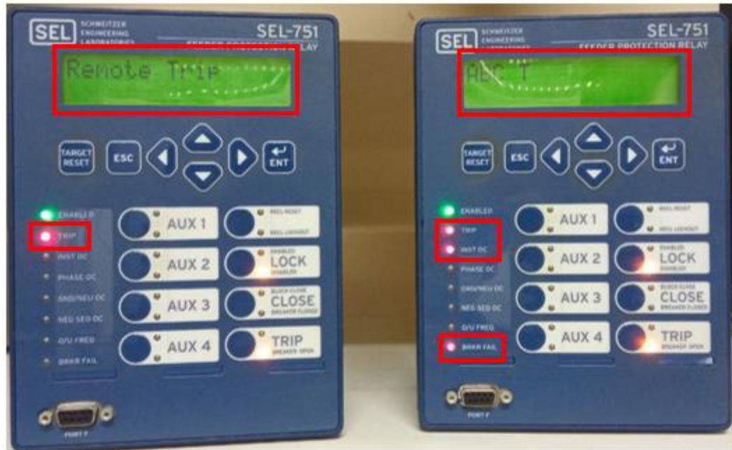
Figura 49 - IEDs físicos após o teste de seletividade lógica com falha de disjuntor
