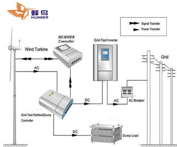
Figura 13 - Configuração do Sistema Eólico conectado a Rede
