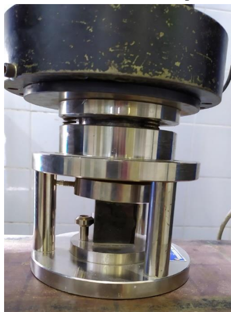
Figura 10 – Ruptura de um dos corpos de prova submetidos ao ensaio de resistência à compressão
