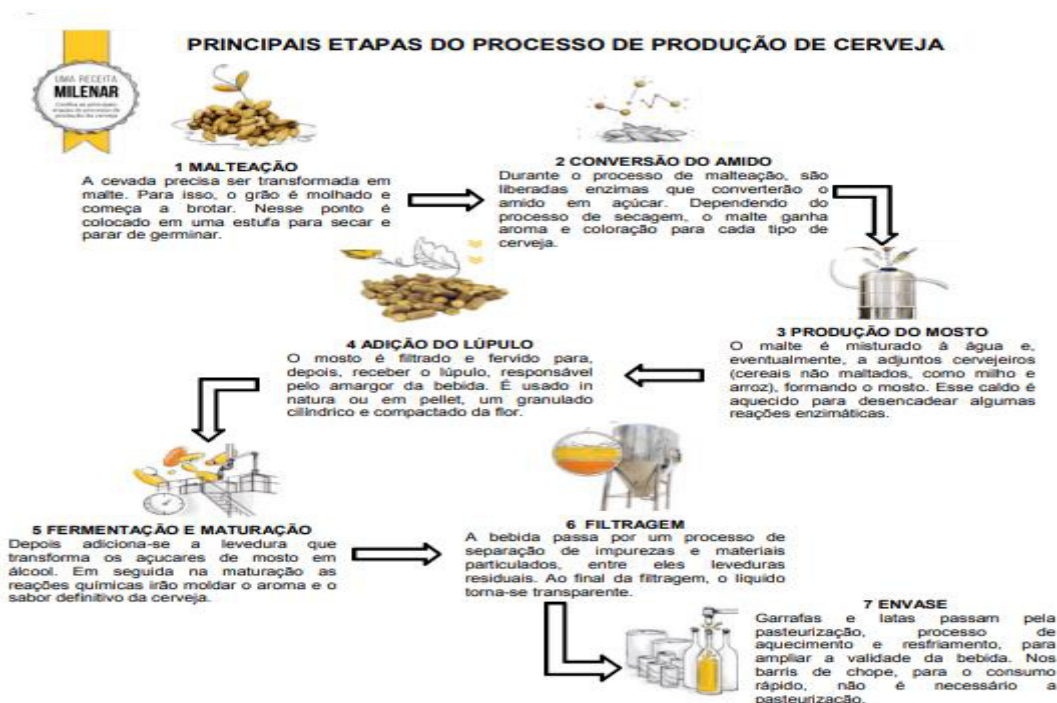
Figura 2. Principais etapas do processo de produção da cerveja
