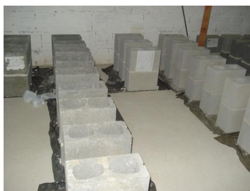
Figura 49: Prisma de blocos de concreto para ensaio.
