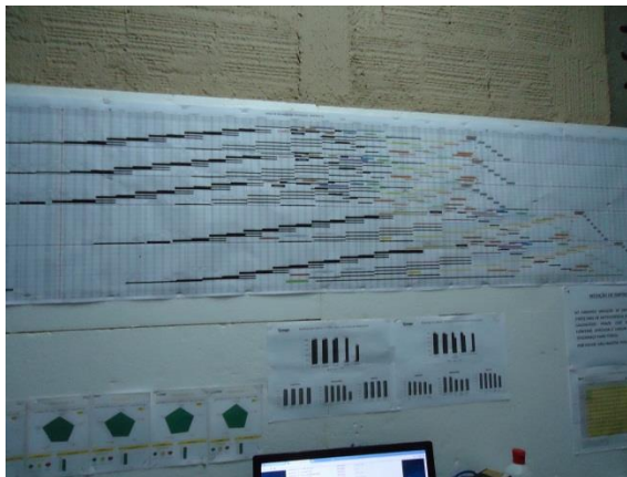
Figura 51: Planejamento de longo prazo com linha de Balanço.
