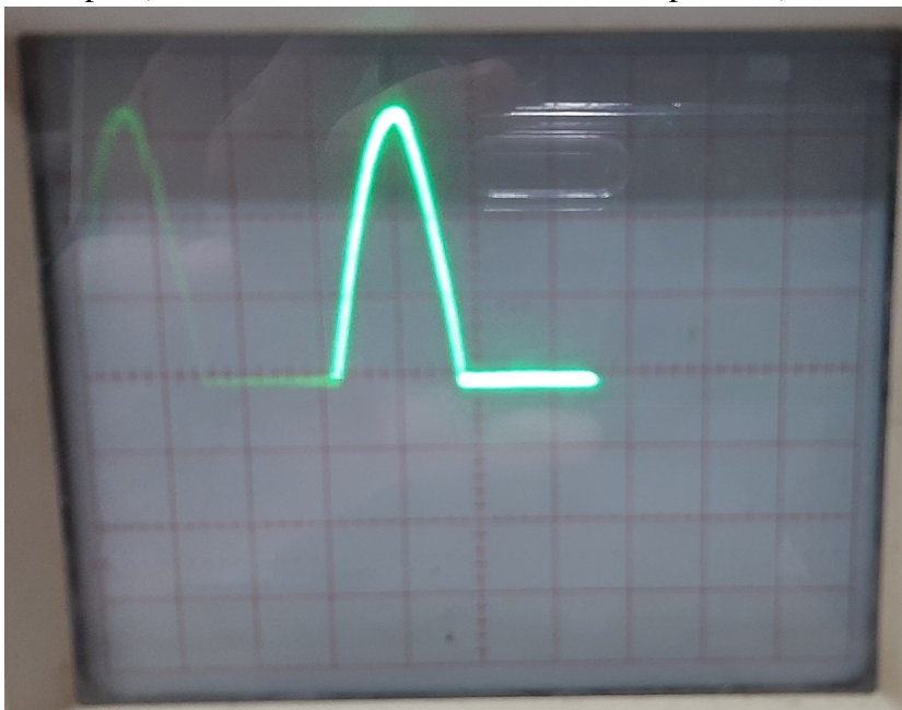
Figura 80 – Representação da forma da onda observada no osciloscópio (retificador de meia onda sem filtro capacitivo).
