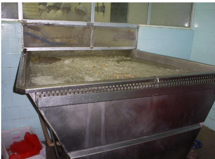
Figura 3. Tanque separador de gelo, utilizado na lavagem e descongelamento do camarão proveniente da pesca extrativa, na IPESCA, em Fortaleza-Ceará.
