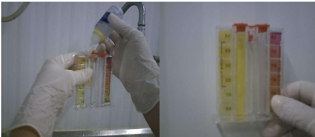
Figura 5. Teste da concentração de cloro da água utilizada no beneficiamento do camarão na IPESCA, em Fortaleza - Ceará.
