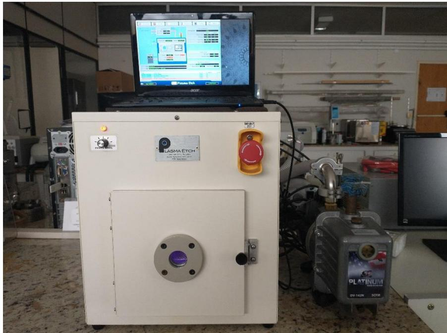
Figura 6 - Reator de plasma de descarga luminescente utilizado. (Autoria Própria)
