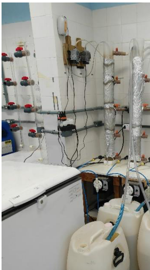
Figura 5 – Vista Geral dos Reatores de Lodo Granular Aeróbio R1 (controle) e R2 (fármacos)
