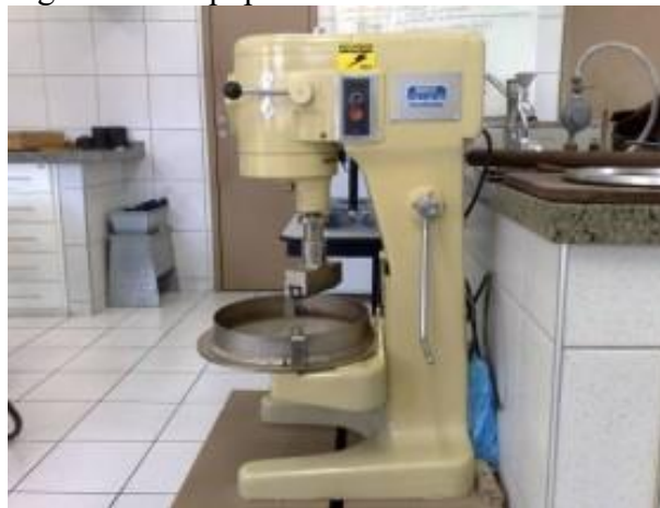
Figura 15 – Equipamento utilizado no WTAT
