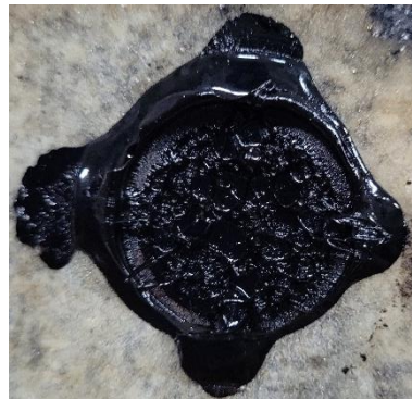
Figura 50 – Exemplo de mecanismo de falha coesiva.
