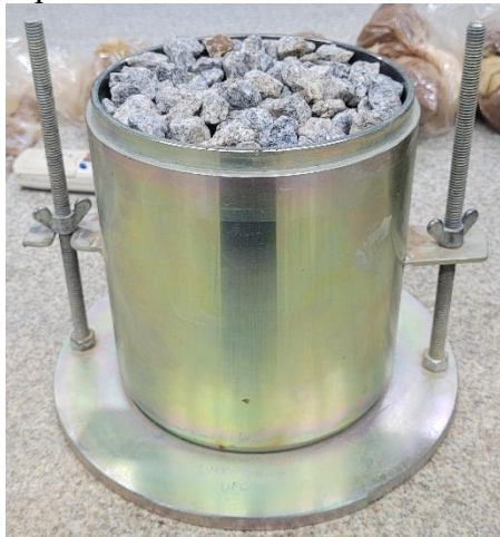
Figura 35 – Determinação da massa específica solta
