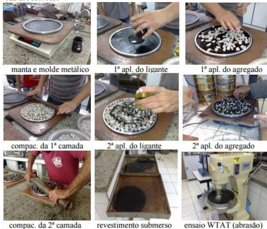
Figura 16 – Metodologia utilizada por Loiola para moldagem e ensaio em laboratório
