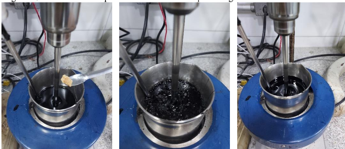
Figura 28 – Processo de expansão durante modificação do ligante
