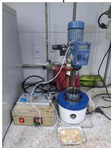
Figura 27 – Misturador de baixo cisalhamento, manta aquecedora e controlador de temperatura
