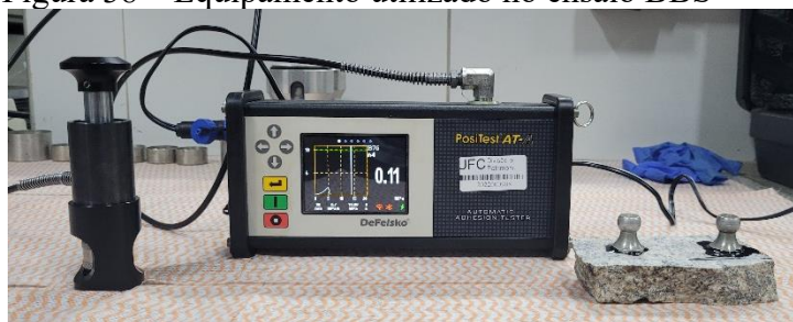
Figura 38 – Equipamento utilizado no ensaio BBS
