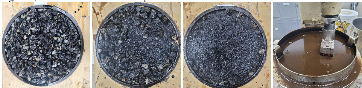
Figura 48 – Amostra com cura incompleta no WTAT
