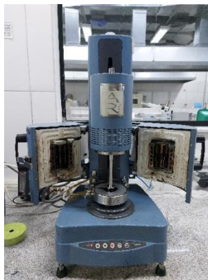
Figura 33 – Reômetro de cisalhamento dinâmico AR-2000
