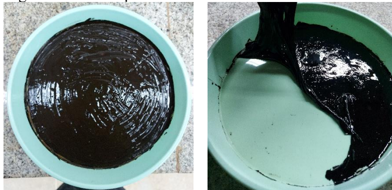
Figura 32 – Obtenção do resíduo asfáltico
