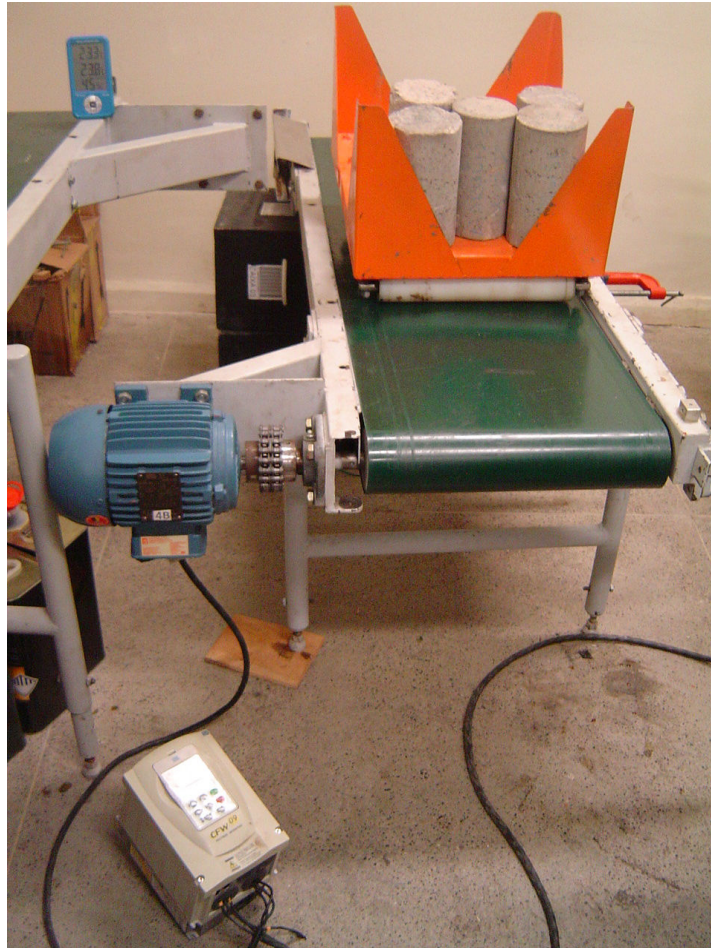
Figura 5.13 - Correia transportadora do LAMOTRIZ/UFC acionada por conversor de frequência e MIT acoplado diretamente
