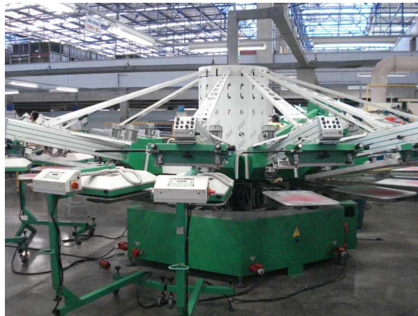
Figura 3.5 – Máquina São Roque de estampagem (Fonte: Acervo do Autor)
