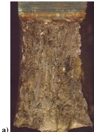
Figura 8. Fractografia da Liga 3. Aspecto da fratura à temperatura de 100 °C.
