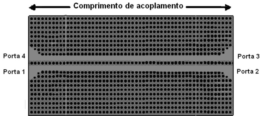
Figura 6.13. Acoplador embutido cristal fotônico com estrutura triangular de hastes dielétricas submersas em ar [73, 74].
