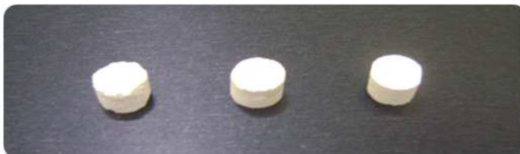
Figura 21. Corpos de prova cilíndricos 12 mm x 6 mm.
