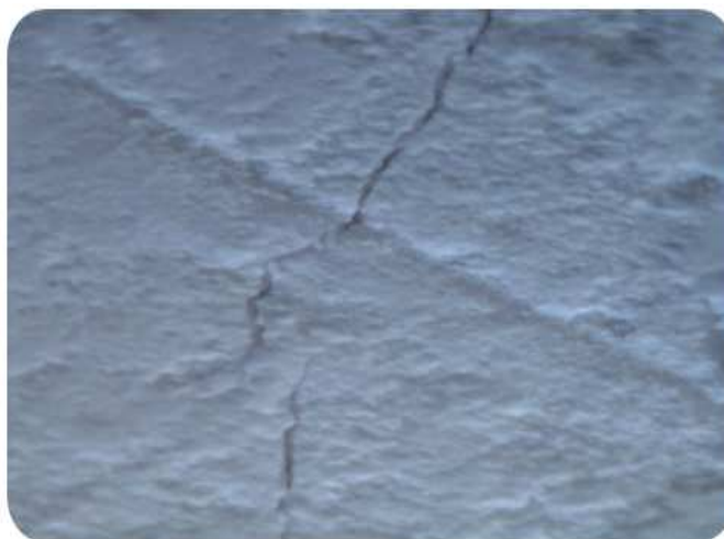
Figura 45. Fotografia de fraturas apresentadas pelas amostras de biocimento submetidas ao ensaio de compressão diametral (50X).
