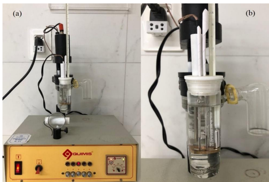
Figura 1 – (a) Determinador de ponto de fusão com um termômetro acoplado (b) Amostras no tubo capilar inseridas no equipamento.
