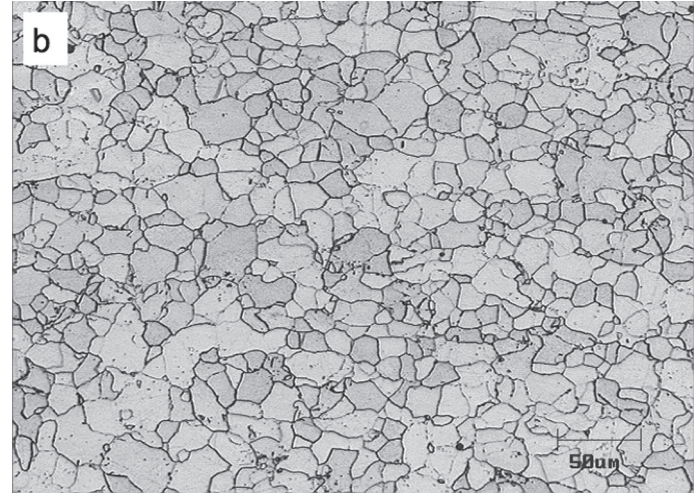
Figura 5. Microestrutura do material tratado em forno tipo contínuo, como recebido (ataque de Villela's). (a) sentido longitudinal à laminação; (b) sentido transversal à laminação.
