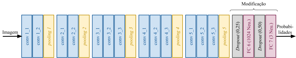
Figura 26 – Arquitetura VGG-16 modificada proposta como Módulo 2. Fonte: elaboração própria.
