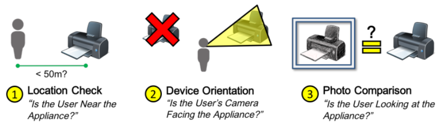
Figura 9 – Processo de reconhecimento aplicação Snap to It. Fonte (FREITAS et al. , 2016)
