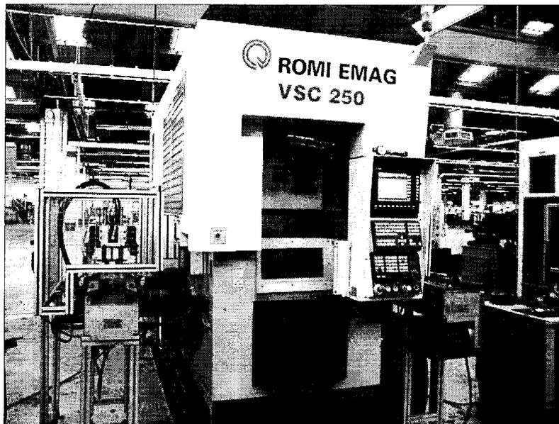
Figura 1. Centro de Torneamento Vertical Romi-EMAG VSC 250.
