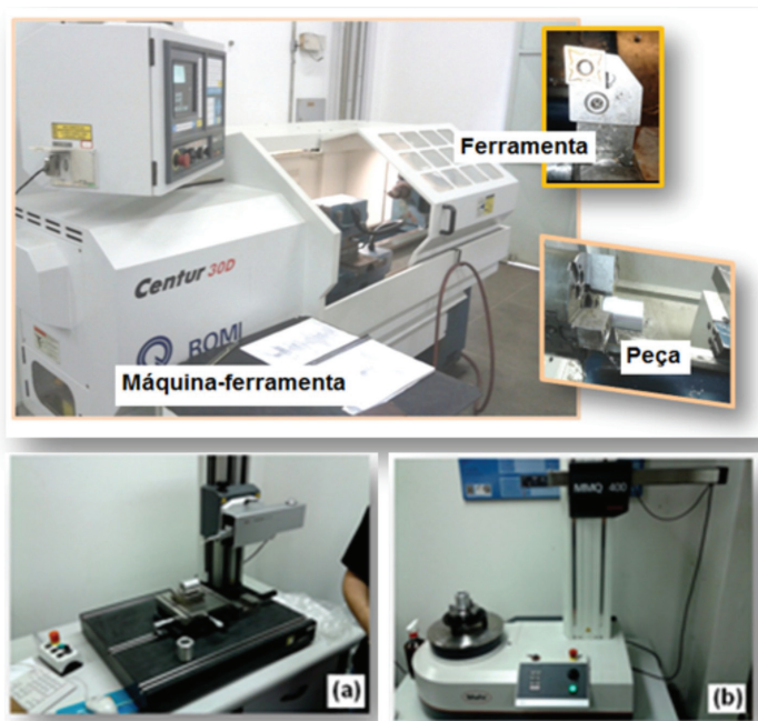
Instrumentos para medição da rugosidade (a), circularidade e cilíndricidade (b).
