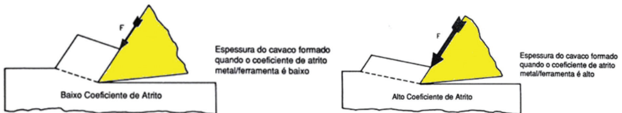
Figura 1 - Influência do coeficiente de atrito na usinagem.
