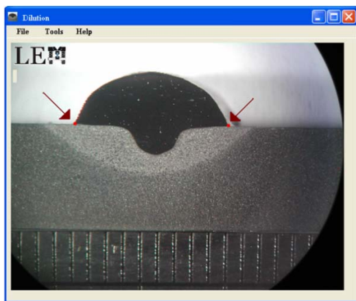
Fig 3: Selecção dos pontos nas extremidades do metal de solda.
