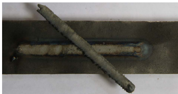
Figura 11. Cordão de solda de liga de níquel destacado do expontaneamente devido a falta de fusão e ausência de coalescência com o substrato [22].
