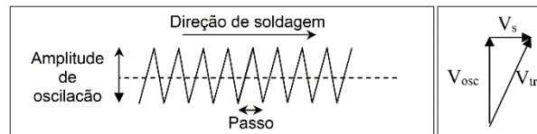
Figura 3. Desenho esquemático do movimento descrito no tecimento triangular.
